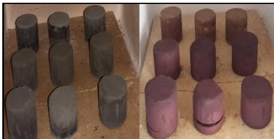
Εικόνα 2.13: Μορφοποιημένα (αριστερά) και θερμασμένα κεραμικά (δεξιά)
