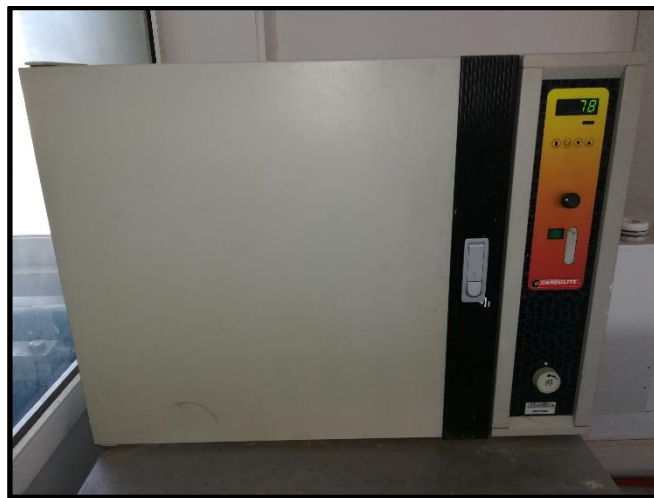
Εικόνα 2.7: Πυριαντήριο PF 60/200 Carbolite
